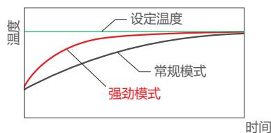
可持续20分钟最大气流操作和压缩机运转，使房间的温度（制冷或制热）迅速达到舒适。
