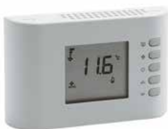
AFS/CR25: Gestione unità 2-4 tubi con/senza valvole. Uscite: 1 motore AC~230V 1...3Vel. + 2 valvole ON/OFF, PWM, 3-Punti
