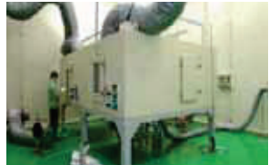
Prova calorimetrica Misurare della capacità di raffreddamento / riscaldamento.
