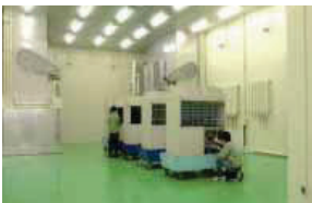
Test a temperatura costante Verifica le prestazioni del prodotto in modalità raffreddamento / riscaldamento in base alle diverse condizioni di temperatura e umidità.
