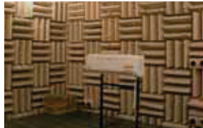
Test rumorosità Test di rumore in camera anecoica alle varie condizioni di funzionamento.
