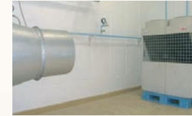
اختبار قوة تحمل الوحدة الخارجية عند الأمطار Water shower testing
